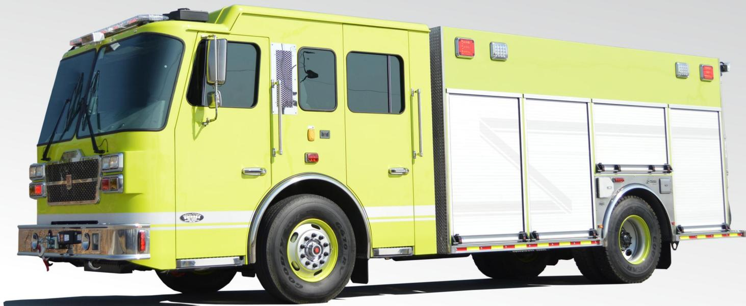
Las unidades HAZMAT modelo HZ77 son excelentes para la atención de emergencias químicas y/o materiales peligrosos las cuales se fabrican en cumplimiento con la norma NFPA #1901, las carrocerías son fabricadas completamente en aluminio cal. 8 y cal. 10. Se diseña para maximizar los espacios interiores por la colocación de estantes, tableros para herramientas para todo el equipo necesario en la emergencia.
